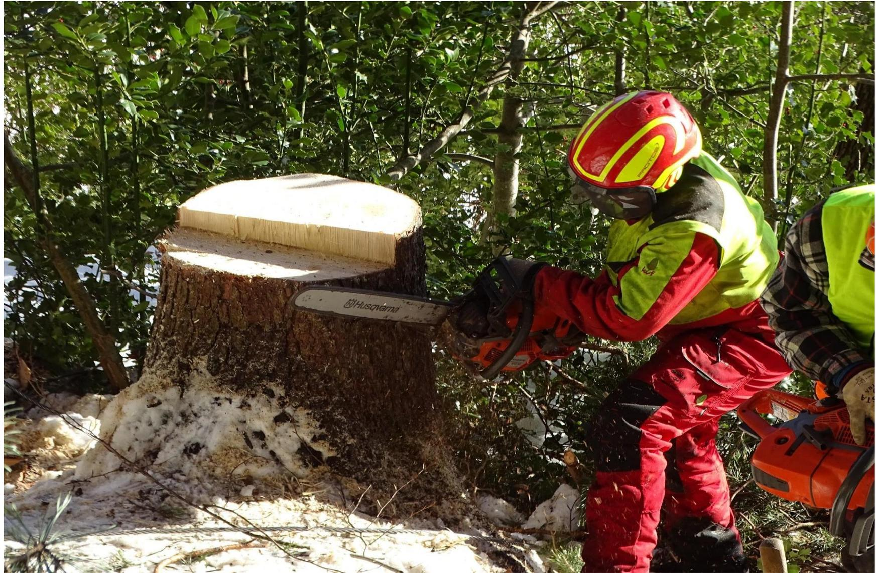
Mit der Motorsäge wird zur Führung des Drahtseiles eine Kerbe in einen frisch gefällten Wurzelstock geschnitten.
