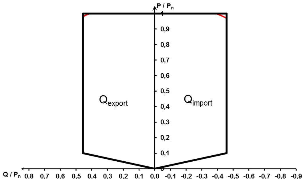
Abb. 1: Blindleistungsstellbereich in Abhängigkeit von Wirkleistung und Netzspannung
