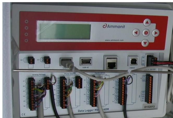
Abbildung 25: \_ Ammonit Datenlogger Typ Meteo-40M
