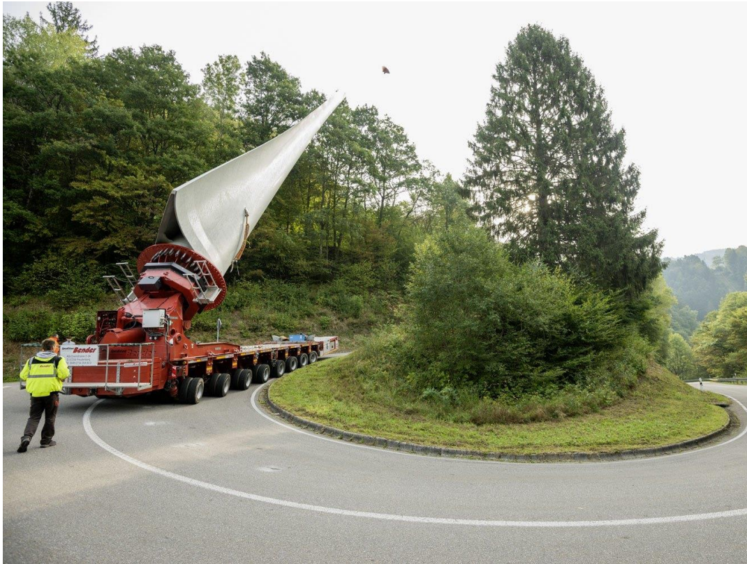
Abbildung 14: Transport Rotorblatt mit SPMT
