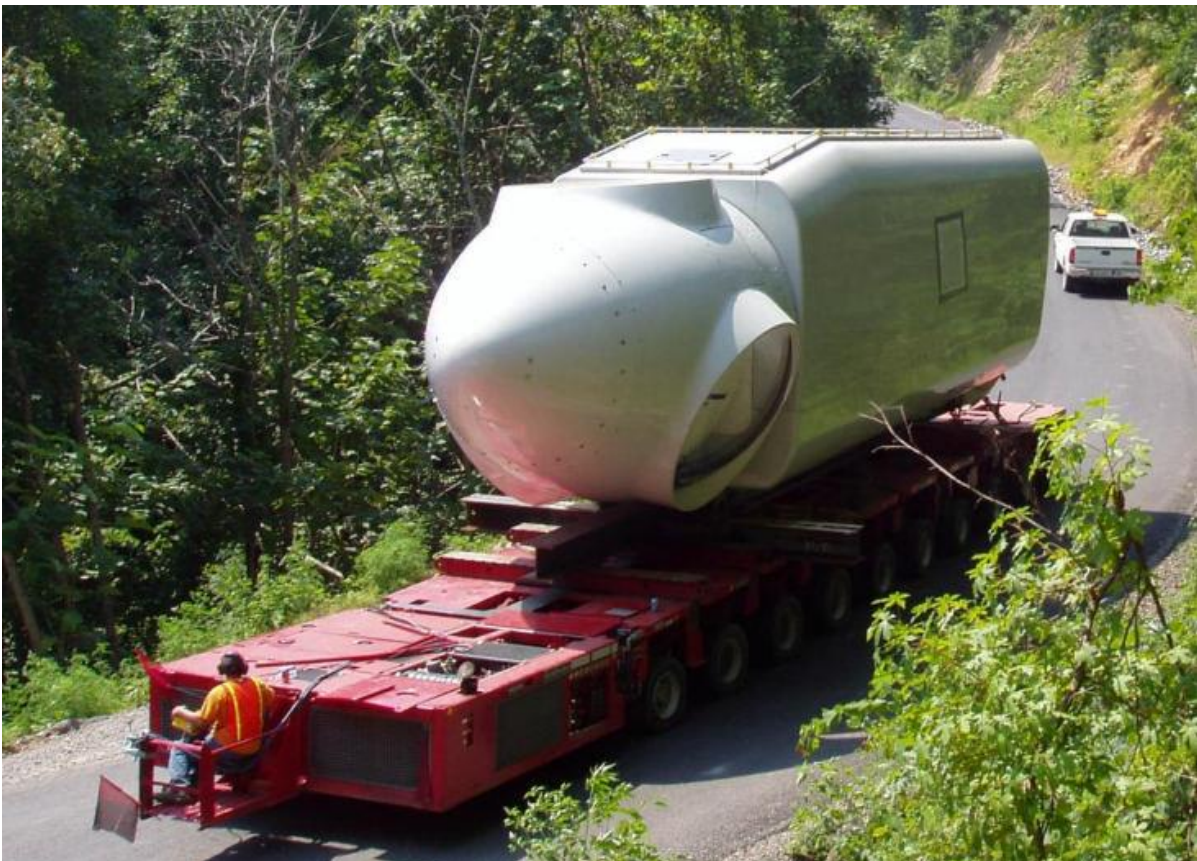
Abbildung 13: Transport Gondel mit SPMT
