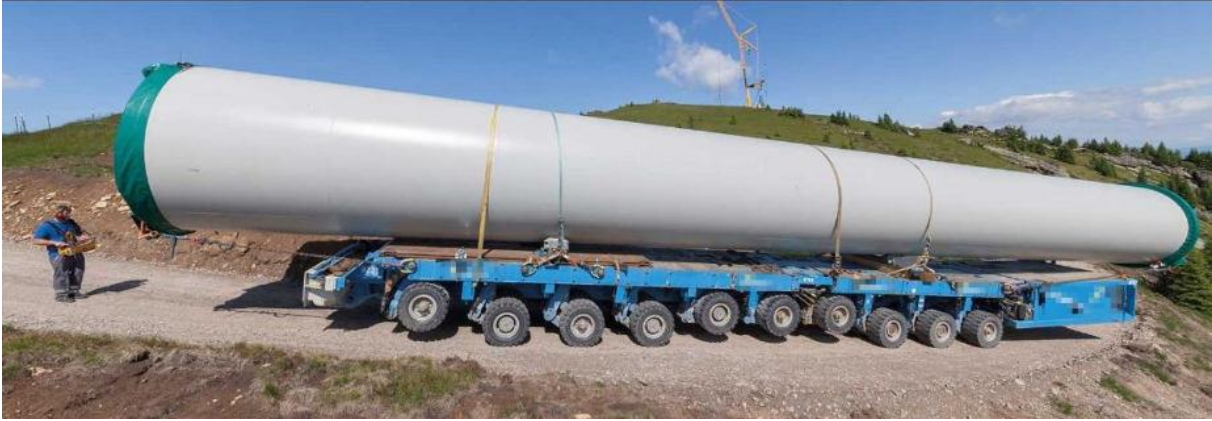
Abbildung 12: Transport Turmelement mit SPMT
