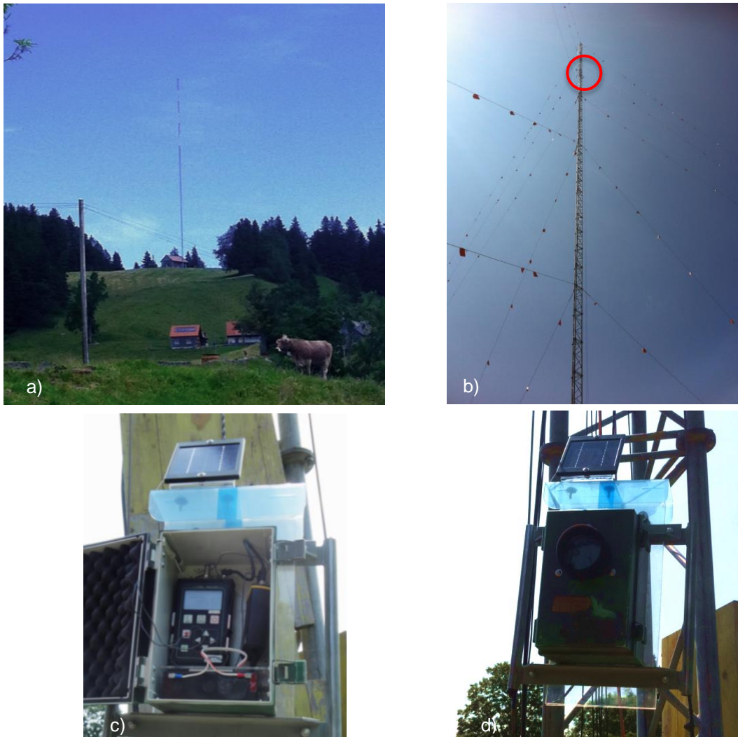
Abb. 2. Messstation: a) Messmast 100m und Umgebung b) Messhöhe auf 72m c.) Inhalt einer Bat-Unit mit den Aufzeichnungsgeräten (Batcorder, Steuerung) und autonomer Stromversorgung (Bleigel-Akku). d) Geschlossene Bat-Unit mit Scheibenmikrophon
