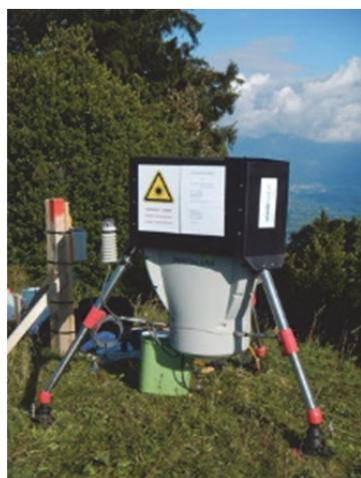
Abb. 8 SpiDAR Wind LIDAR, Standort
