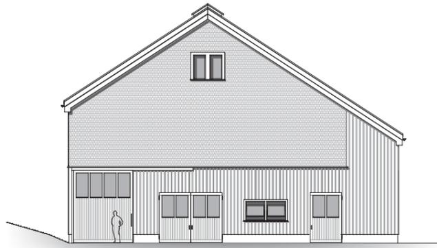
Bauten im Appenzellerland weisen nur einen äusserst geringen Dachvorsprung auf, um den teils heftigen Föhnstürmen möglichst wenig Angriffsfläche zu bieten. Dies hat zur Folge, dass die Fassaden mit der Zeit bis zum Dach eine regelmässige, silbergraue Färbung annehmen.
