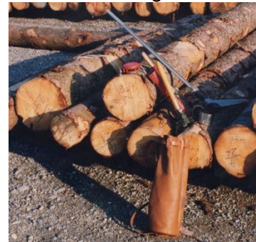
Einmesskluppe, Einmannmessband, Nummerierhammer mit Schuhwichse und Lederetui
