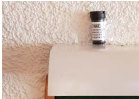
Dosimeter zur Radonmessung, plaziert an Schulzimmerwand
