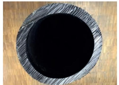
Querschnitt des eingezogenen PE-Rohr mit einem Durchmesser von 18 cm und einer Wandstärke von 18 mm. Diese Wandstärke braucht es, damit es beim Einziehen des neuen Rohres auch allfällige Kratzer verträgt.
